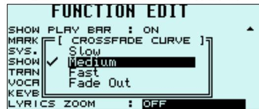
Im Auswahlménü der Crossfade-Kurven (Slow, Medium, Fast und Fade Out) aktivieren Sie durch Druck auf die **Edit**-Taste die Umgebung, in der die verfügbaren Fading-Kurven bearbeitet und individuell abgestimmt werden können. Die Parameter im Feldbereich **FALL** legen fest, wie die Lautstärke des auszublenenden Songs reduziert wird, während die Parameter im Feldbereich **RAISE** sich auf den einzublendenden Song beziehen. Die Parameter sind im Einzelnen folgende:
