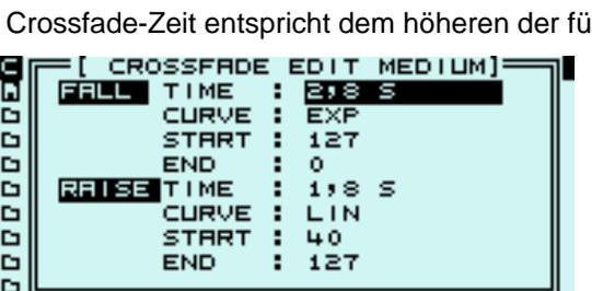
Die Kurven sind bereichsweise voneinander unabhängig, sodass es bspw. möglich ist, unterschiedliche Kurven für den MIDI- und den WAVE-Bereich festzulegen. Die Einstellungen der Kurven können Sie in der Datei **MACHINE.INI** abspeichern, damit sie automatisch beim Einschalten des Geräts geladen werden.
